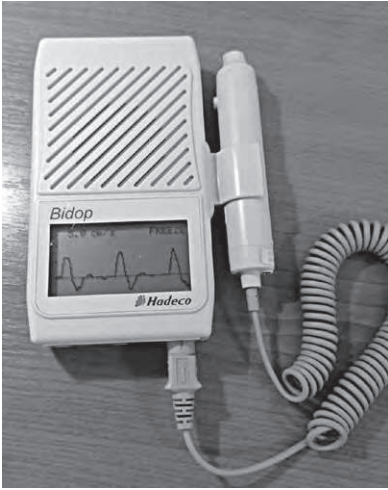
1.2.1. ábra. Kijelzővel rendelkező kézi Doppler-készülék. A monitoron a végtagi artériákra jellemző, normális trifázisos görbe látható
